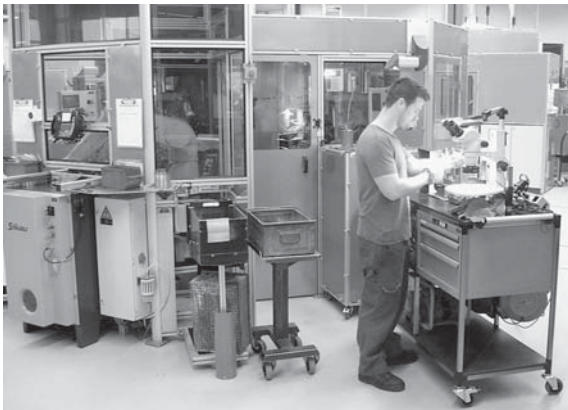
Le régleur et son chariot mobile devant une cellule de taillage
