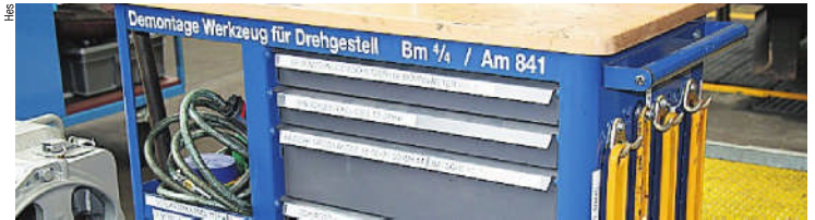
On regroupe les outils spécifiques à tel ou tel véhicule sur des chariots mobiles.
